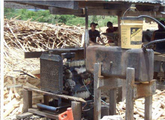
Imagen 2 Fotografía donde se puede observar el recipiente conteniendo combustible para la maquinaria
